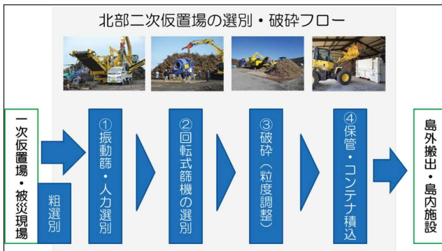
図 1-3 北部二次仮置場の選別・破砕工程
